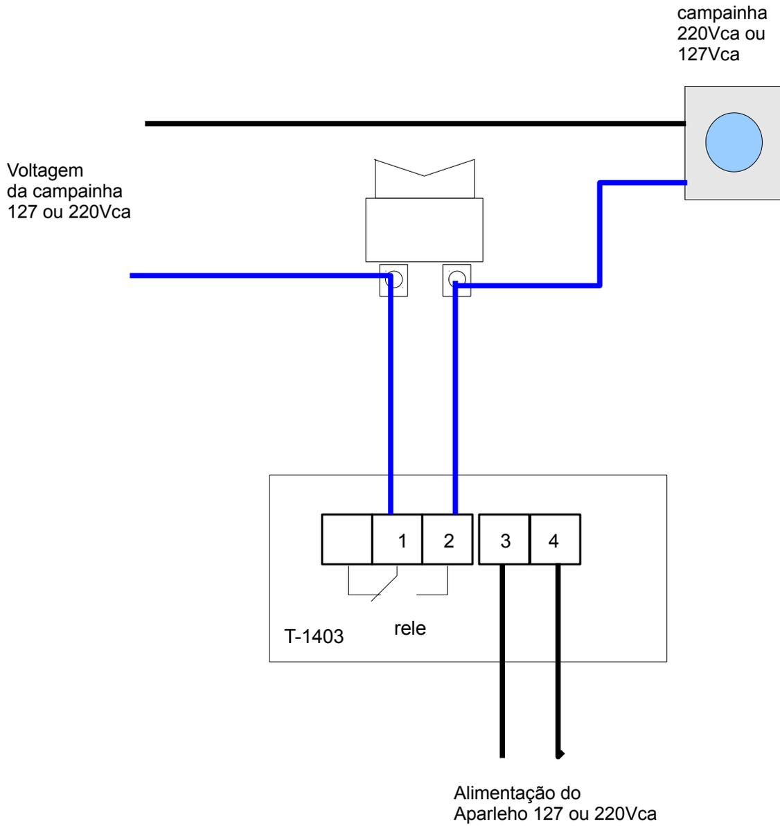
**NOTA: O rele é eletricamente isolado. Não sai tensão dele. Tem que ser alimentado como mostrado na figura.**
