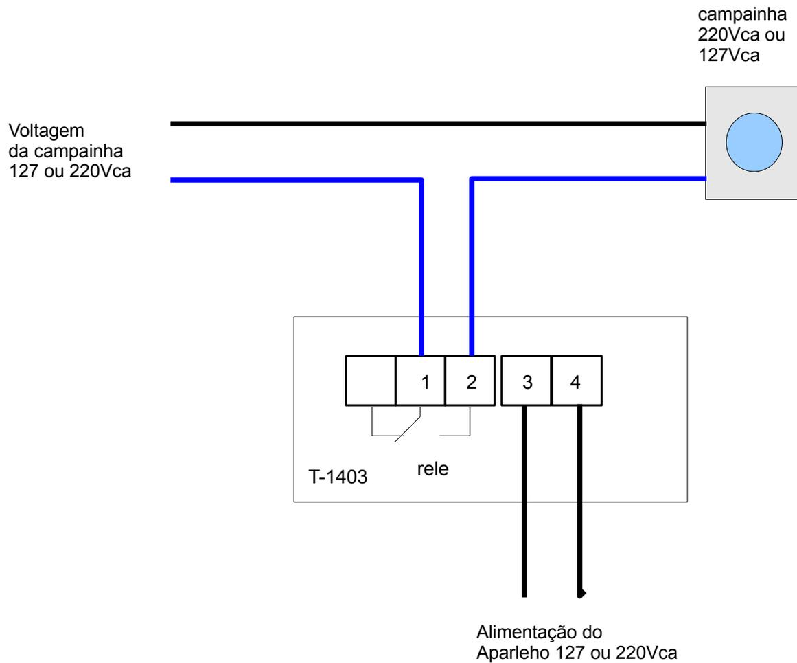
**NOTA: O rele é eletricamente isolado. Não sai tensão dele. Tem que ser alimentado como mostrado na figura.**
