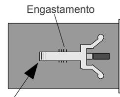
Para prender o gabinete ao painel, afaste a parte apontada do gabinete (levante para fora da superfície da parede da caixa) e empurre contra a chapa do painel. Para tirar, levante a parte apontada pela seta e puxe para tras.
